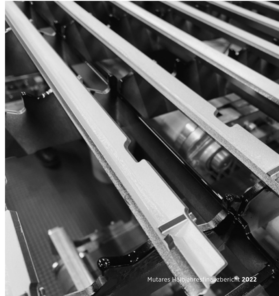
Spritzgussteile in der Vorrichtung fertig zur Montage
