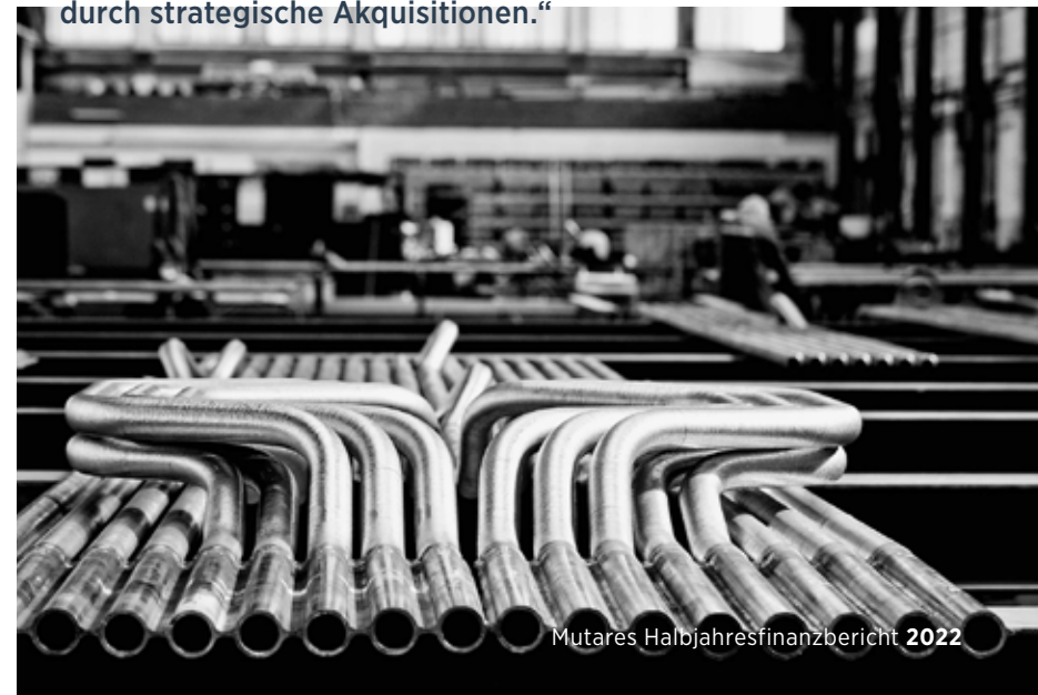
Rohrausbiegungen als Teil eines Austauschs von Kesseldruckteilen
